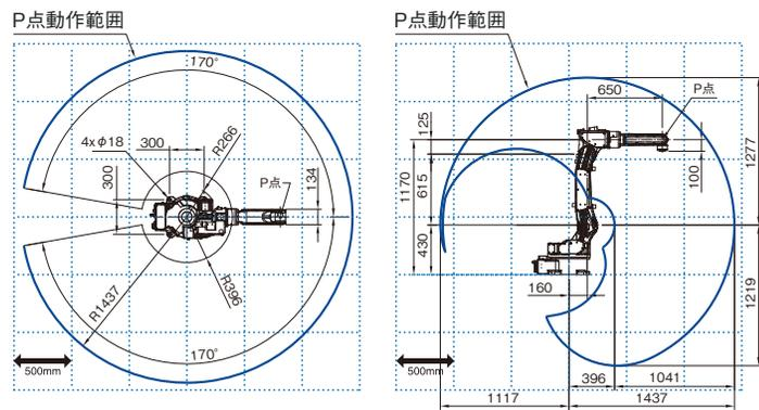
□: 床置き設置で溶接用途の場合    ⊗+□: 左記以外の場合
